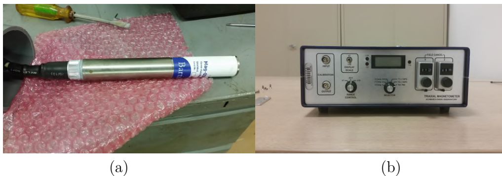
Figura 4.2 - Fotos do (a) sensor magnético e da (b) unidade de controle e aquisição de dados de um dos magnetômetros da rede Embrace MagNet.
