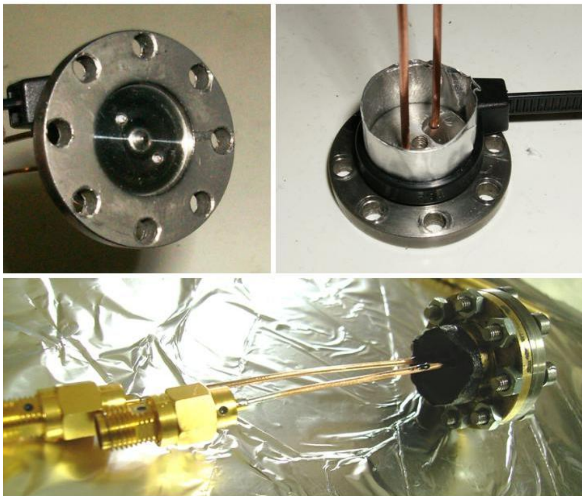
Figura 5.13 – Detalhes da fixação das sondas, com resina epóxi STYCAST 2850 FT, nas cavidades klystron para medições de frequência de ressonância e fator-Q carregado em modo de transmissão.
