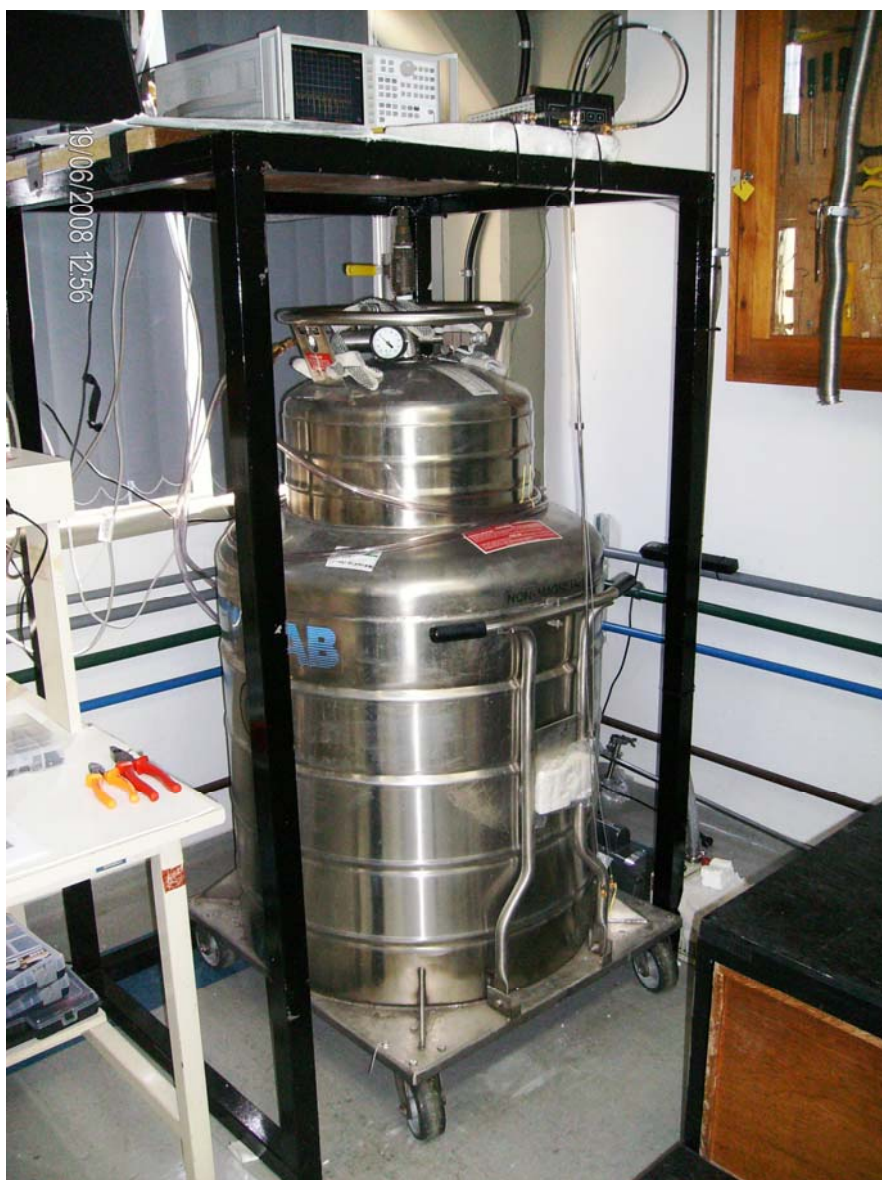
Figura 5.21 – Vista geral da estrutura metálica construída para que o analisador de rede vetorial Agilent Modelo 8722/ES permanecesse na mesma altura do criostato inserido no dewar CRYOFAB CMSH 250, minimizando o comprimento da linha de transmissão utilizada durante as medições.
