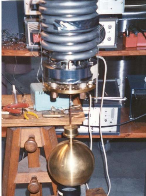
Fig. D.1 – Uma das Esferas Usadas para Medir o Q Mecânico.
