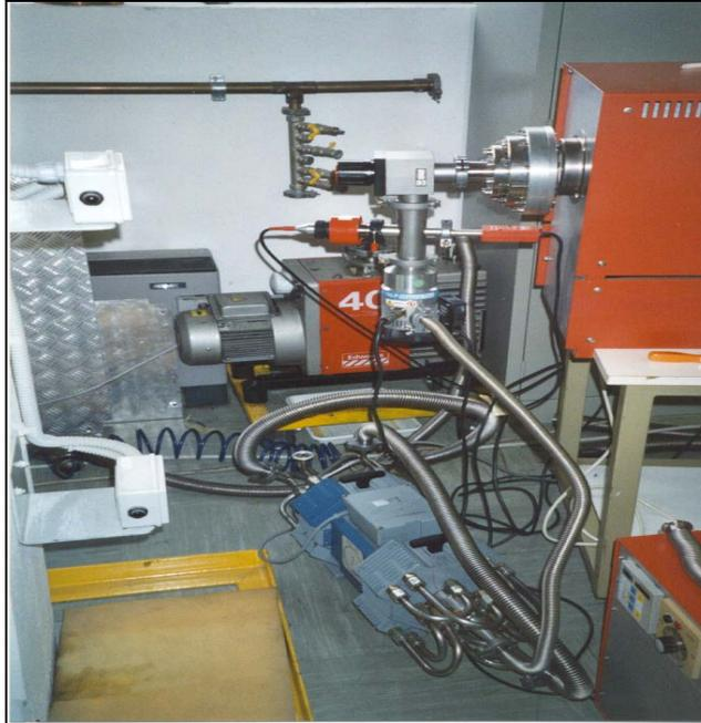
Fig. 6.16- Forno Acoplado a Bombas para Recozimento a Vácuo.
