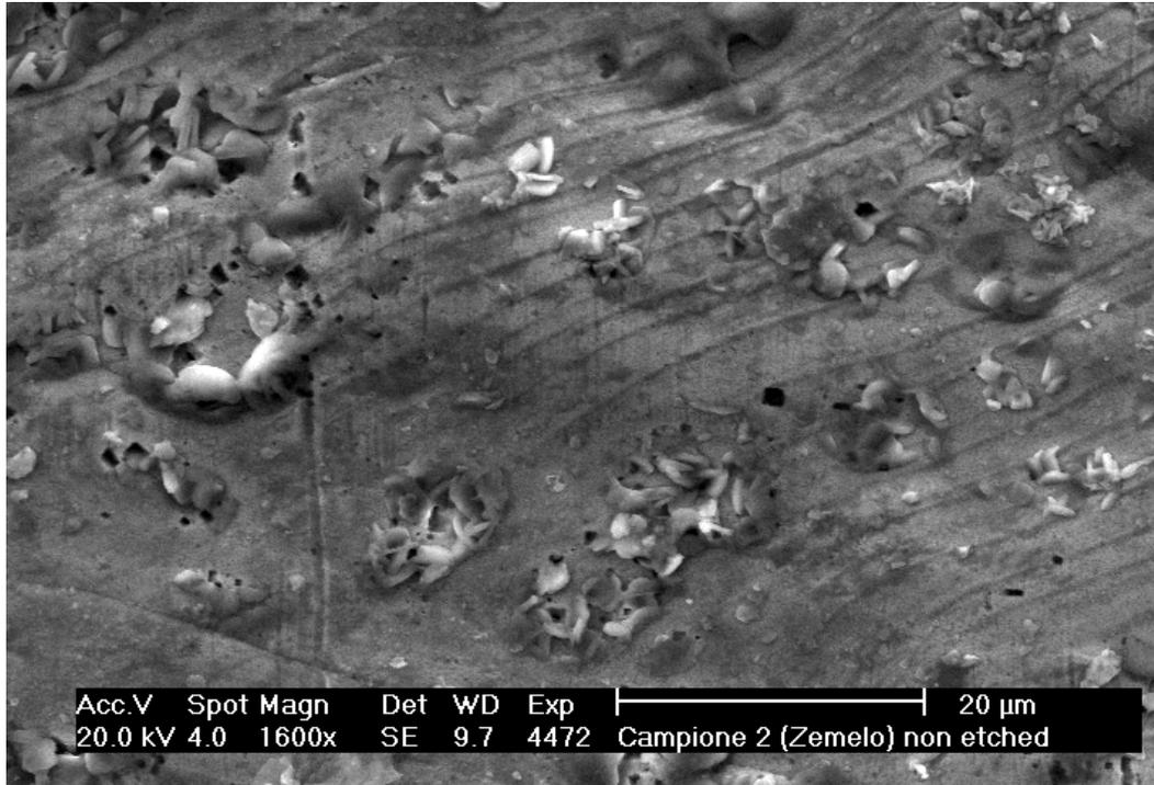
**Fig. E.11- Amostra de cobre OFHC com recozimento em Escala de 20 μm.**
