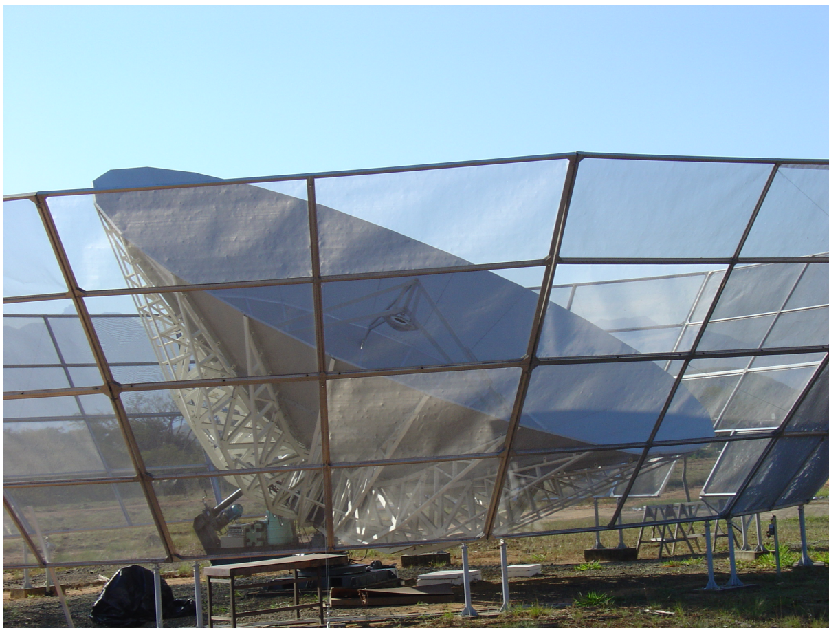
Figura 2.5 - Fotografia do radiotelescópio do projeto GEM instalado no sítio de Cachoeira Paulista.
