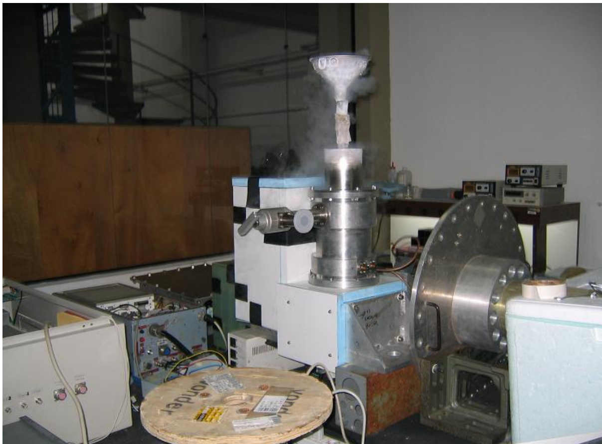
Figura 3.29 - Polarímetro inteiramente montado na bancada, operando em temperaturas criogênicas.
