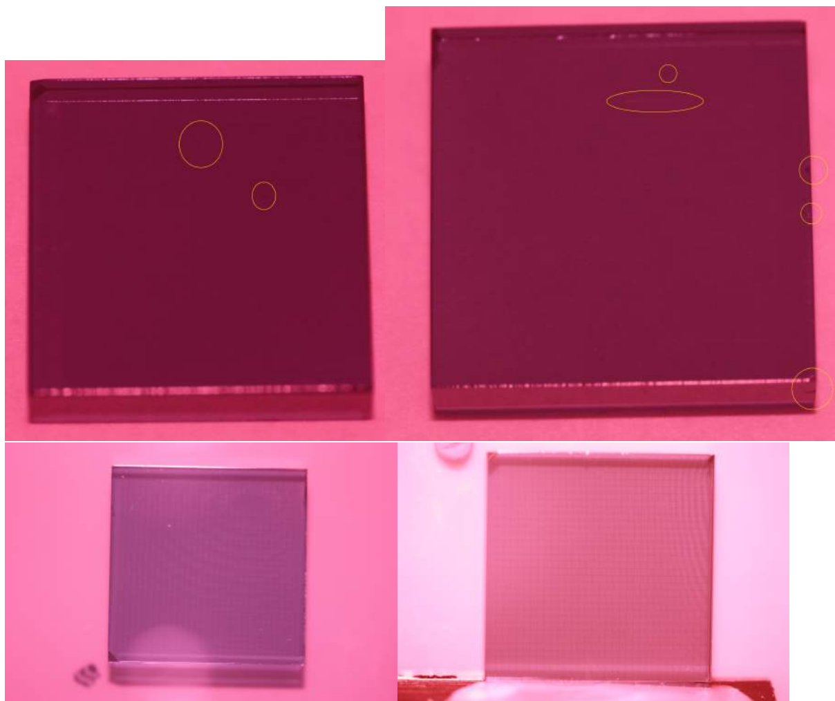
Figura 5.6 - Exemplo de imagens no infravermelho de cristais CZT após a remetalização. Na duas imagens superiores são circulado os defeitos e impurezas do cristal. A imagem inferior direita corresponde ao cristal número 28466 utilizado na DCU X12.
