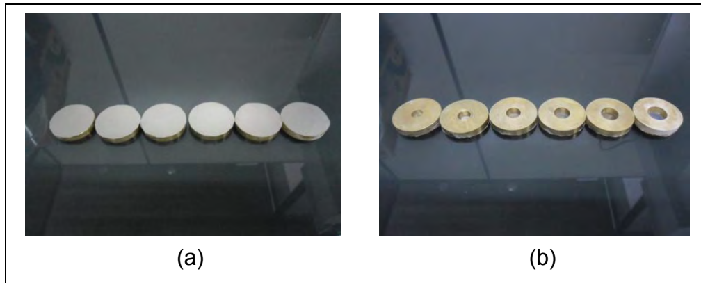
Figura 6.7 - Peças de metal onde foram coladas as membranas de nióbio. (a) Faces onde foram coladas as membranas. (b) Faces com a abertura onde as membranas ficaram livres para oscilar.
