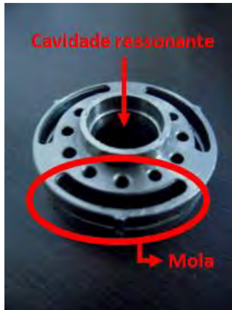
Figura 4.5 - Transdutor de nióbio com molas laterais.
