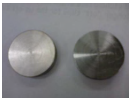
Figura 5.7 - Duas pastilhas de nióbio. A amostra da esquerda sofreu polimento.
