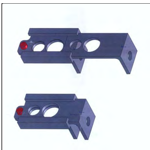
Figura 6.11 - Novo suporte para suspensão das membranas durante o processo de corrosão.
