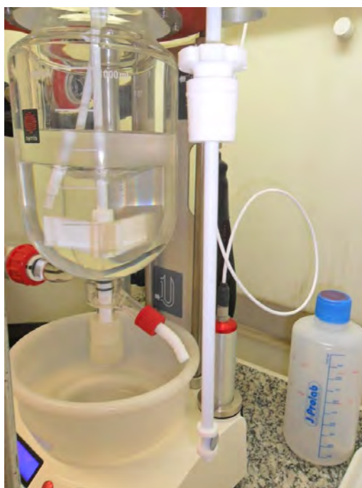
Figura 6.3 - Reator na etapa pré-corrosão.
