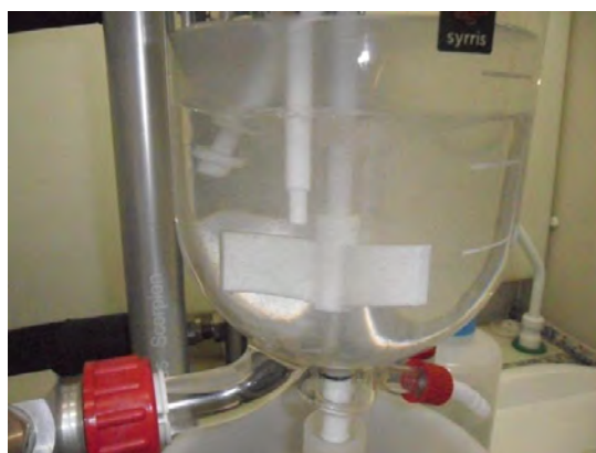
Figura 6.6 - Corrosão química da amostra de silício.
