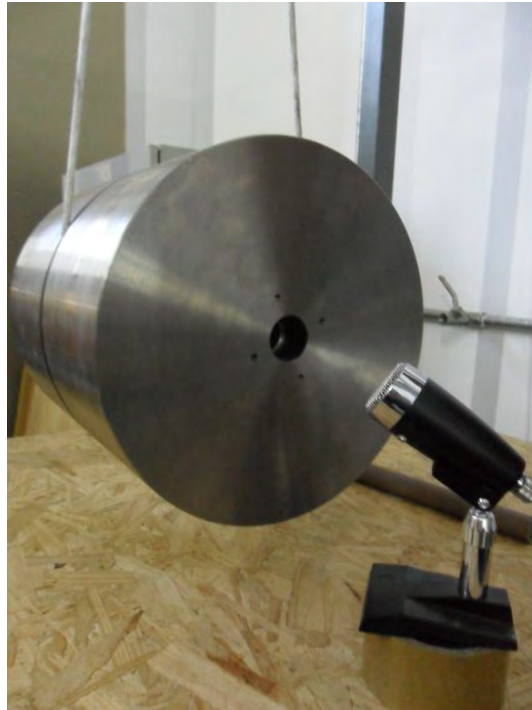
Figura 4.4 - Massa cilíndrica de aço inoxidável utilizada para testes de vibração.
