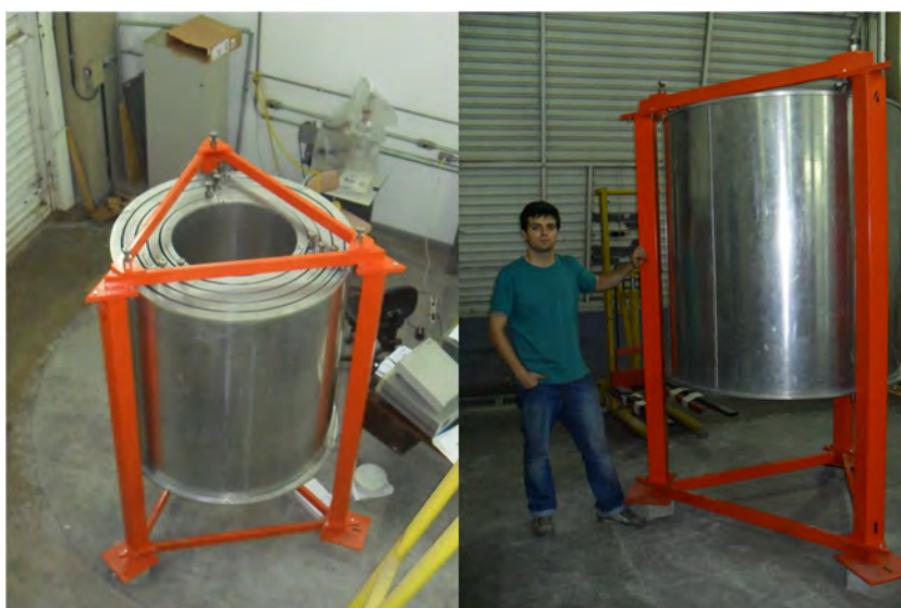
Figura 4.1 - Multi-Nested Pendula montado. À esquerda tem-se a visão superior e à direita é possível obter uma noção da altura do sistema
