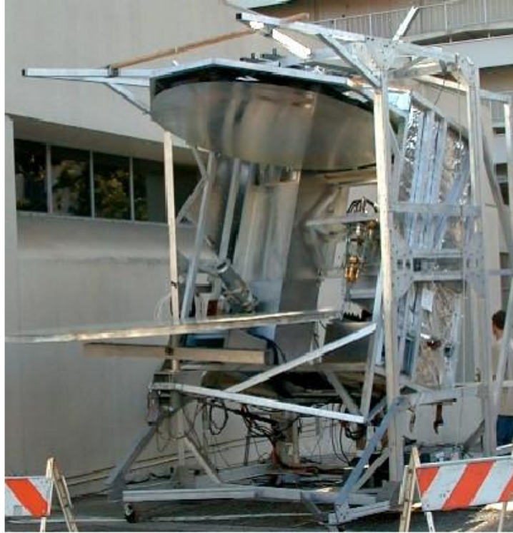
Figura 3.3 - Foto do Telescópio BEAST em frente ao prédio do departamento de Física da UCSB. O espelho plano encontra-se na parte inferior da gôndola, o parabolóide apresenta a superfície refletora visível na parte superior.
