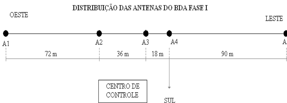
Figura 3.1 - Localização das antenas e as correspondentes linhas base no PBDA. Diagrama tomado de Sawant et al. (2005)
