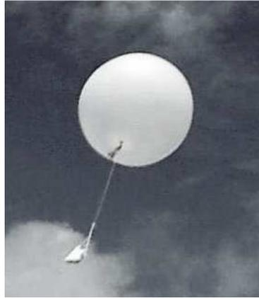
Figura 2: Balão transportando uma radiossonda
