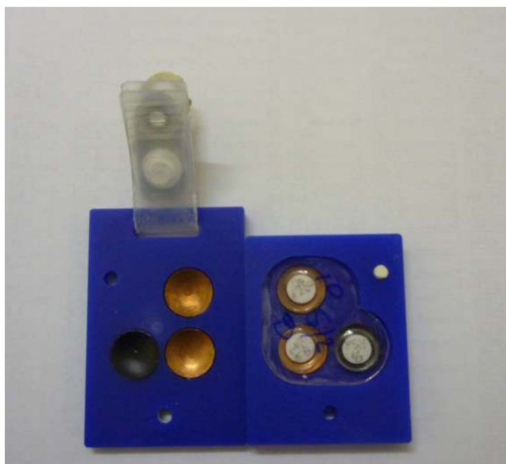
Figura 2 – Estrutura interna do dosímetro METROBRAS.
