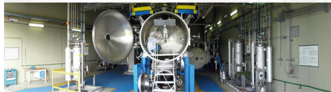
O Banco de Testes com Simulação de Altitudes (B TSA) tem como objetivo testar e qualificar propulsores de satélites. A foto mostra a Câmara de Vácuo Principal do B TSA, de 8.5m 3 de volume, para simulação da altitude
