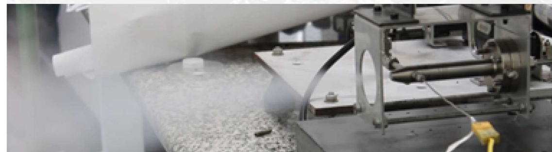
Ensaio de avaliação do catalisador empregado na decomposição do Peróxido de Hidrogênio usado nos propulsores dos satélites
