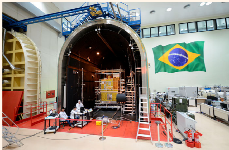
Setup tipo IRA e o modelo de voo do satélite CBERS 04A na câmara vácuo-térmica do INPE
