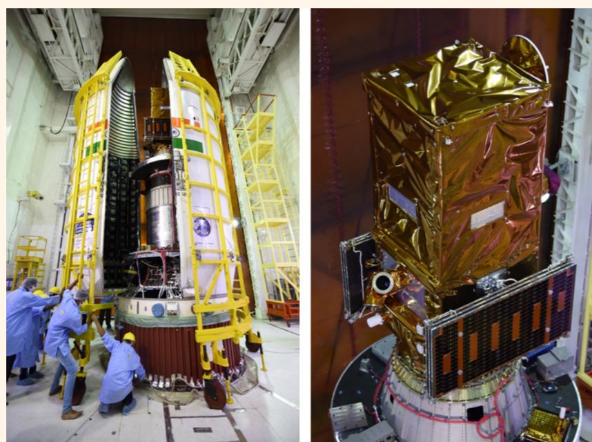
Satélite Amazonia-1 sendo integrado ao foguete lançador PSLV na Índia
