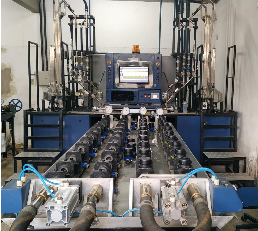
Bancada com princípio Volumétrico. Medidores Ensaados individualmente.
