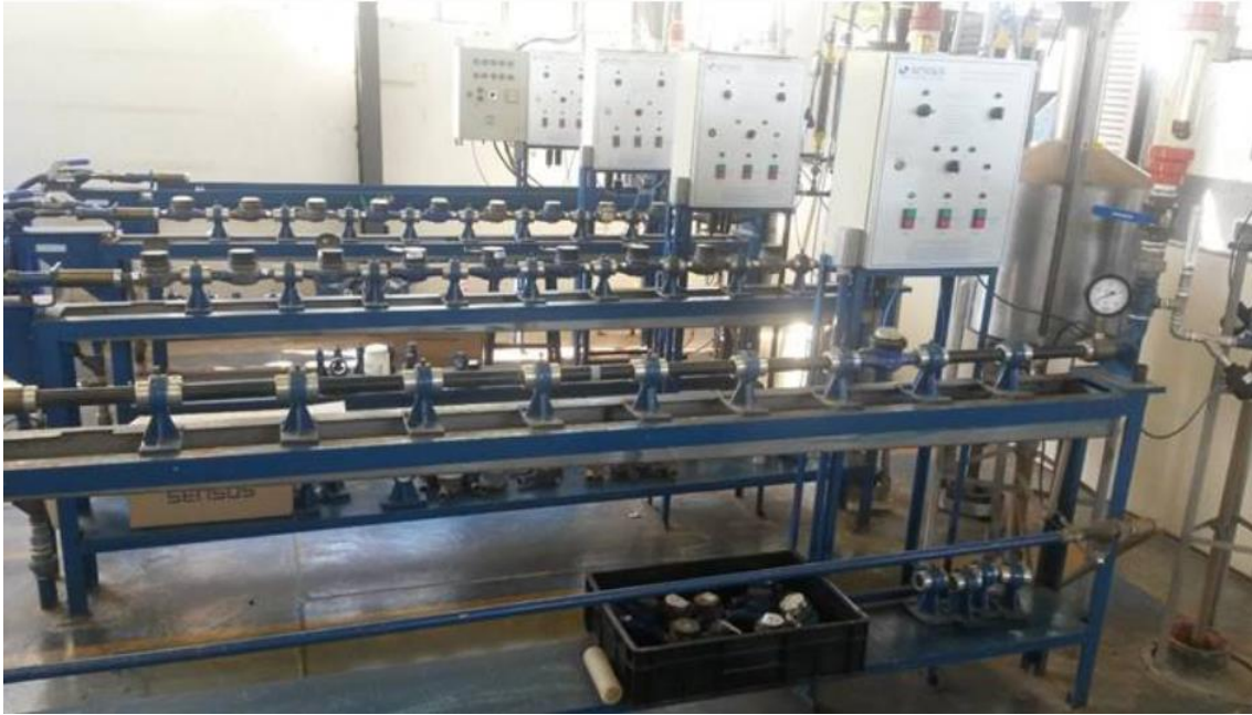
Bancada com princípio Volumétrico Medidores Ensaçados em série
