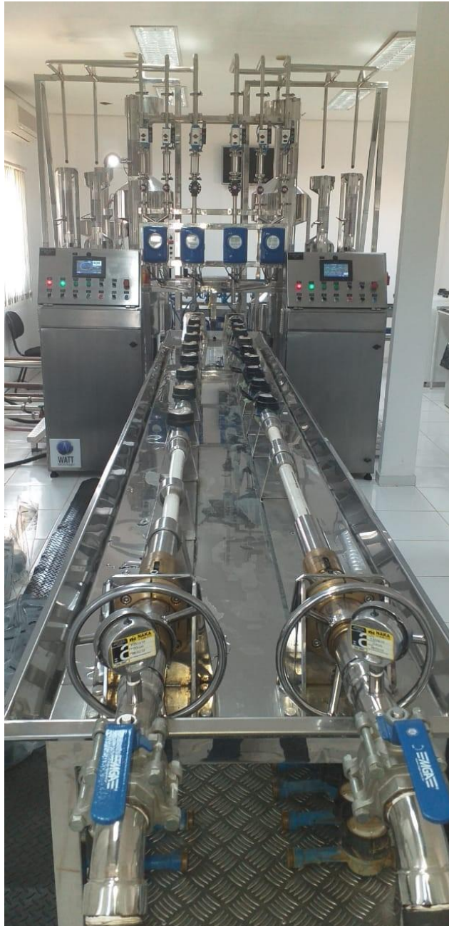
Bancada com princípio Volumétrico Medidores Ensaiaados individualmente.
