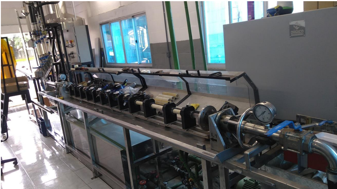
Figura 1 – Bancada de Calibração de Hidrômetros da Empresa - CESAN
