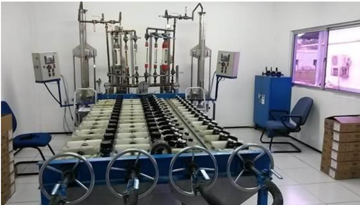
Figura 2 – Bancada de Calibração de Hidrômetros da Empresa - FAE
