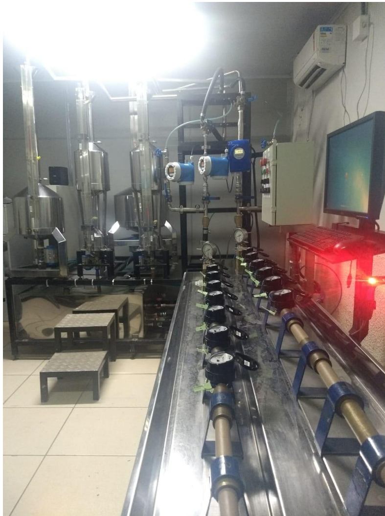
Figura A3 –Bancada de Calibração de Hidrômetros da Empresa – Saga medição
