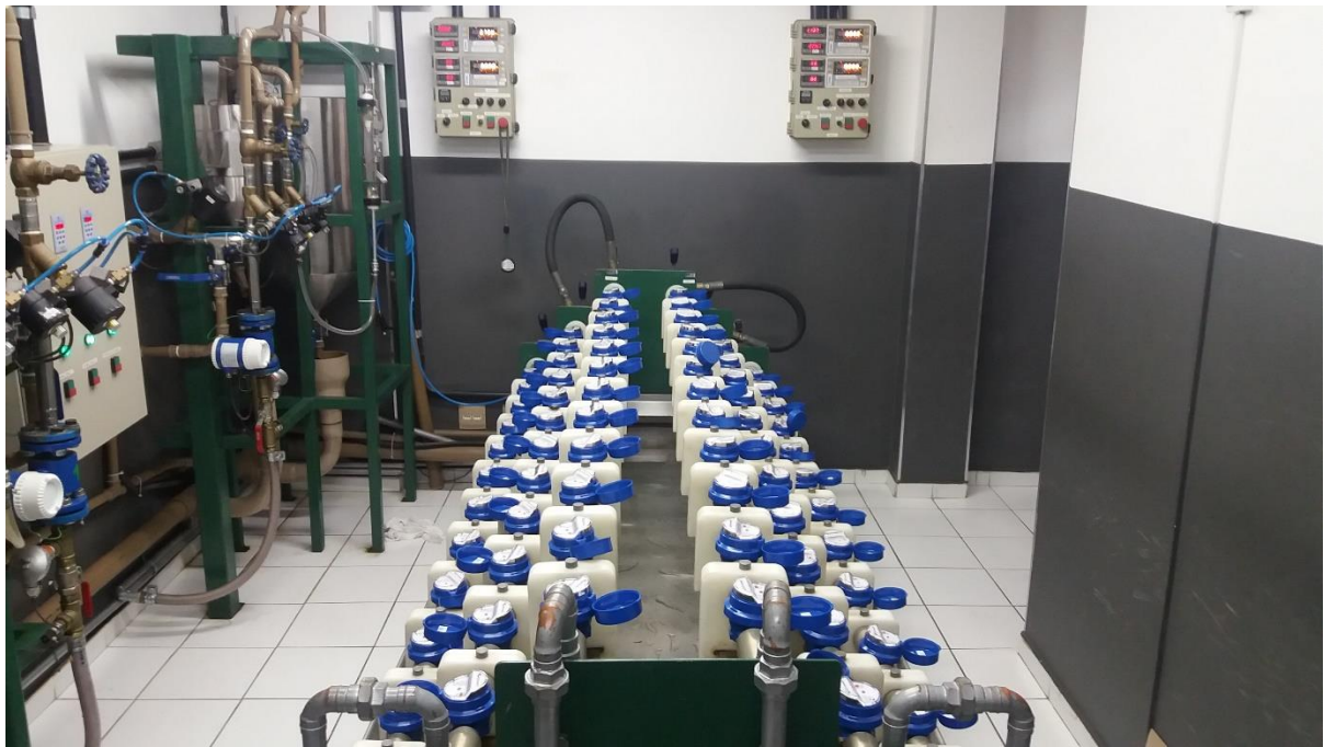
Figura A3 –Bancada de Calibração de Hidrômetros da Empresa - Hidrometer
