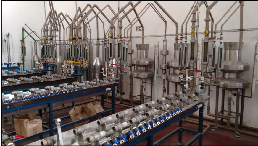
Figura A3 – Bancada de calibração da empresa ENERGRYUS- Bancada "B"
