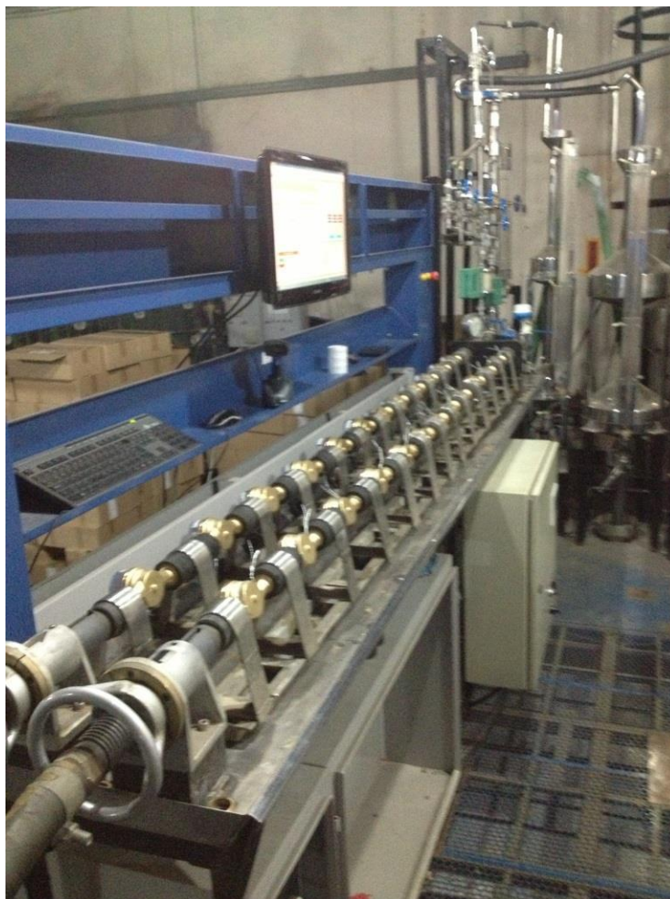
Figura A4 –Bancada de Calibração de Hidrômetros BV 02 da DIGICO
