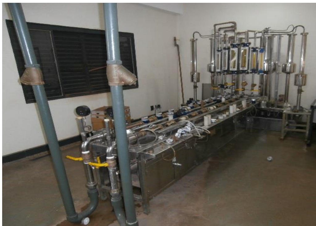
Figura A1 –Bancada de Calibração de Hidrômetros da Empresa - COPASA
