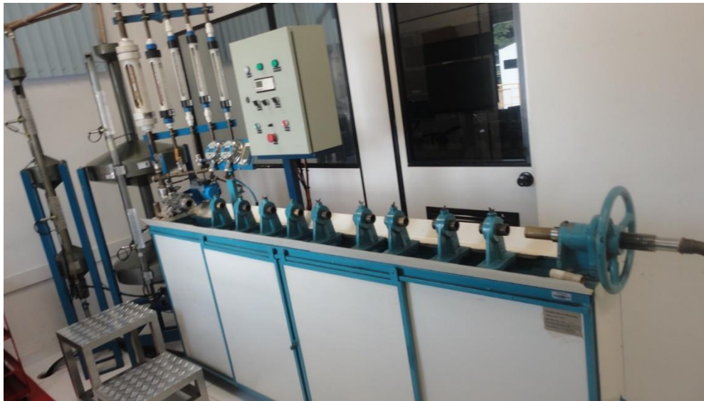
Figura A5 –Bancada de Calibração de Hidrômetros da Empresa - Odebrecht Cachoeiro
