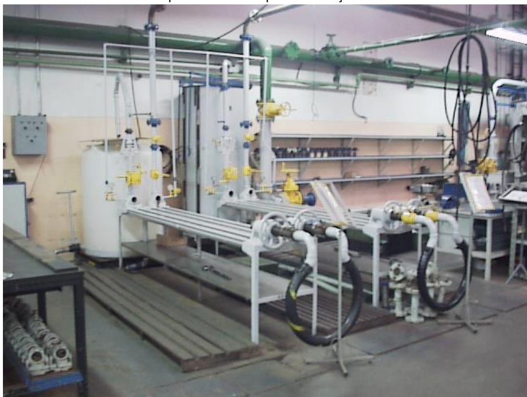
Bancada de ensaio tipo Gravimétrico para verificação de hidrômetros LAO
