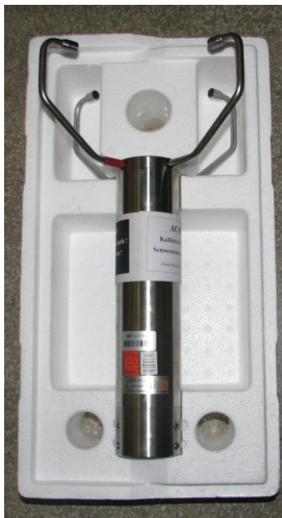
Figura 1. Artefato utilizado na intercomparação - anemômetro ultrassônico
