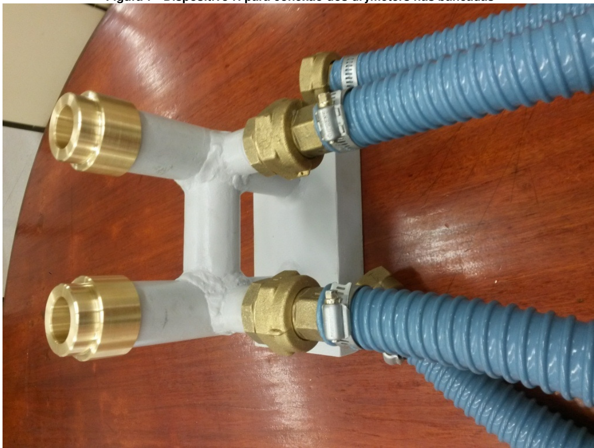
Figura 7– Dispositivo H para conexão dos drymeters nas bancadas
