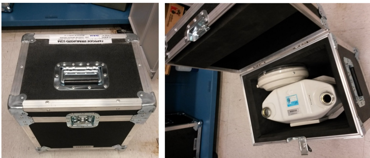
Figura 8 – caixas para acondicionamento dos drymeters a serem usados como padrões itinerantes
