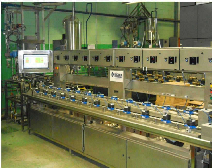
Figura A6 – Bancada de calibração de hidrômetros da empresa COPASA
