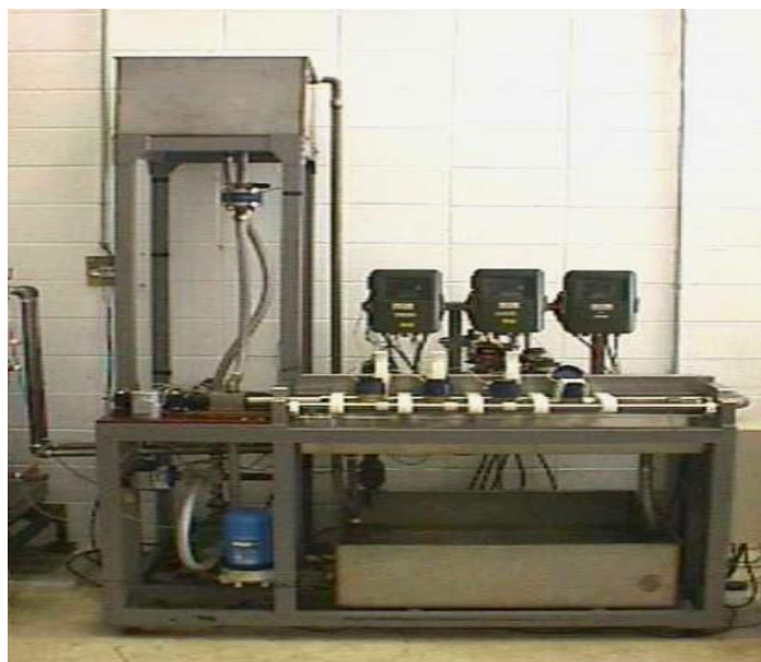
Figura A1 – Bancada de baixas vazões de água do IPT
