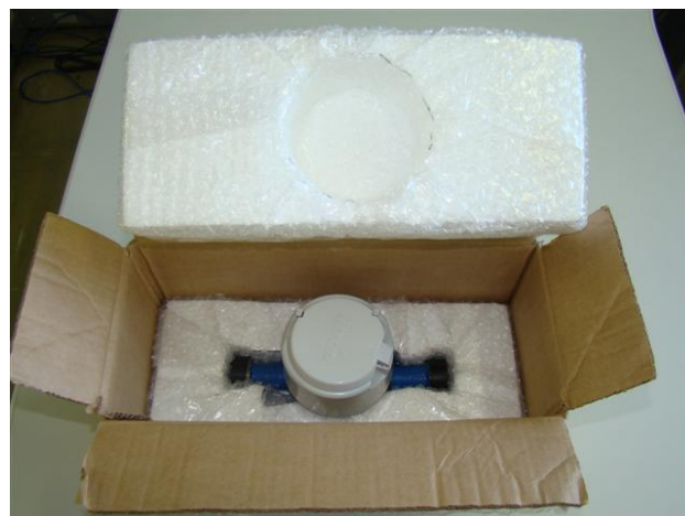
Foto 2 – Revestimento interno da caixa de do padrão itinerante
