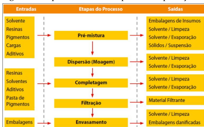
Figura 6 – Esquema ilustrativo do processo de produção de tintas à base de solvente
