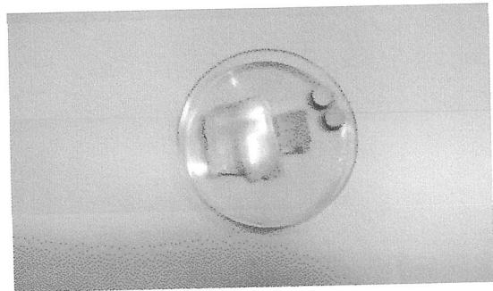
Segundo o relatório de análise, “as pequenas peças com aspecto próximo aos discos cilíndricos foram localizadas em quatro posições entre as camadas da ampola, fazendo a função de espaçadores entre as camadas”. A identificação do material de espaçadores foi feito com a difração de raios X.
