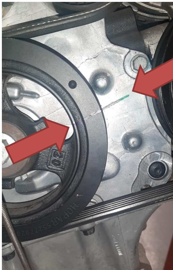
Figura 22 – Posicionamento do pistão do primeiro cilindro no ponto morto superior (PMS)
