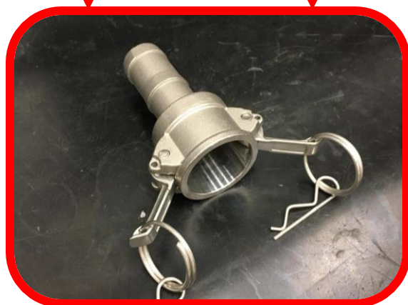
ENGATE REFINARIA ESPIGA \varnothing 26 ALIMENTAÇÃO E RETORNO ÁGUA DO TROCADOR DE CALOR
