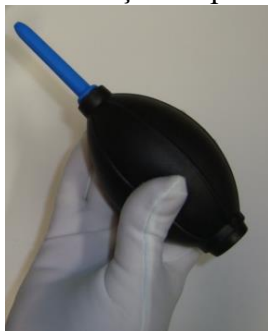
Figura 2 - Exemplo de assoprador para remoção de partículas depositadas nos filtros ópticos
