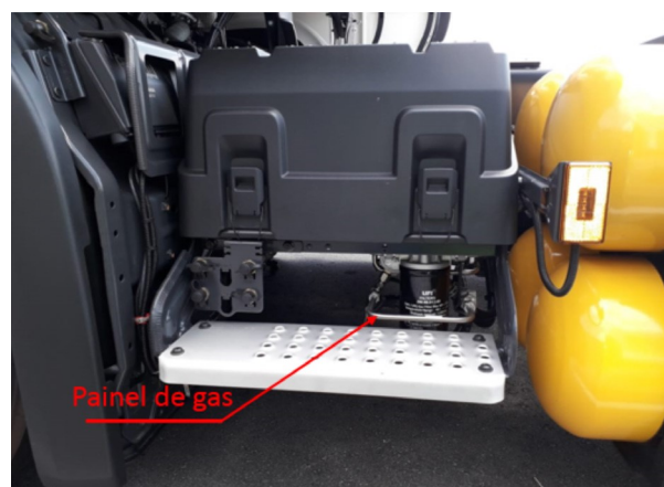
Figura 19: Detalhe da localização do painel de gás sob a caixa de baterias, comum para os veículos
