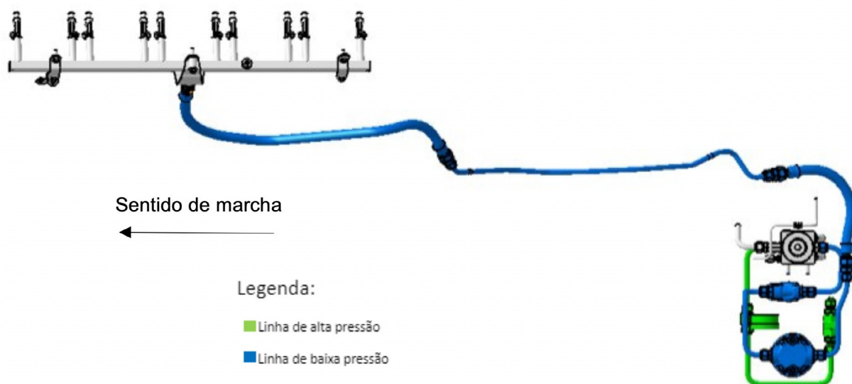
Figura 7: Arquitetura da tubulação de baixa pressão
