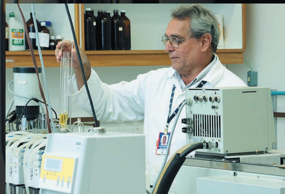
Sistema por Medición de Viscosidad Cinemática (medición de biodiesel)
