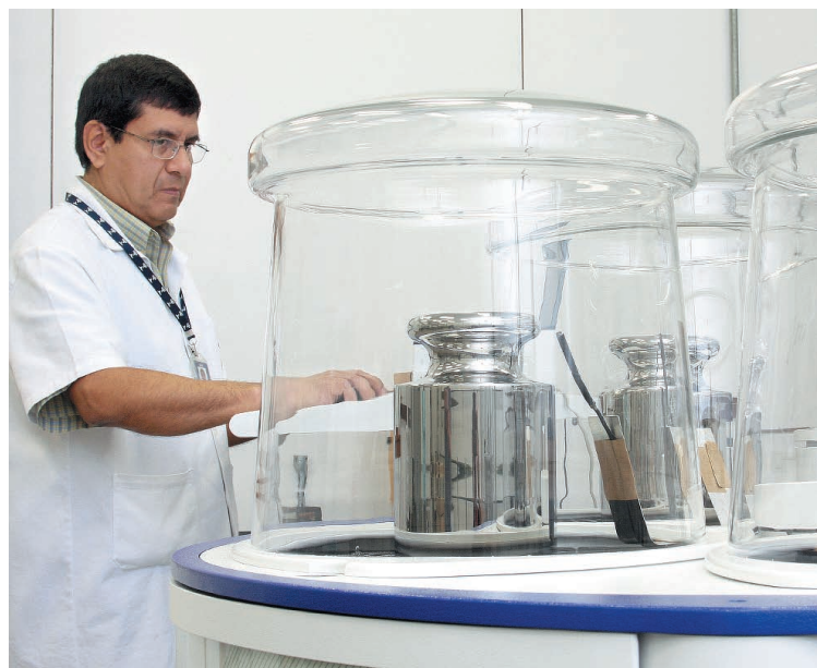
Balanza comparadora de masa de 64 kg, con resolución de 0,1 mg
