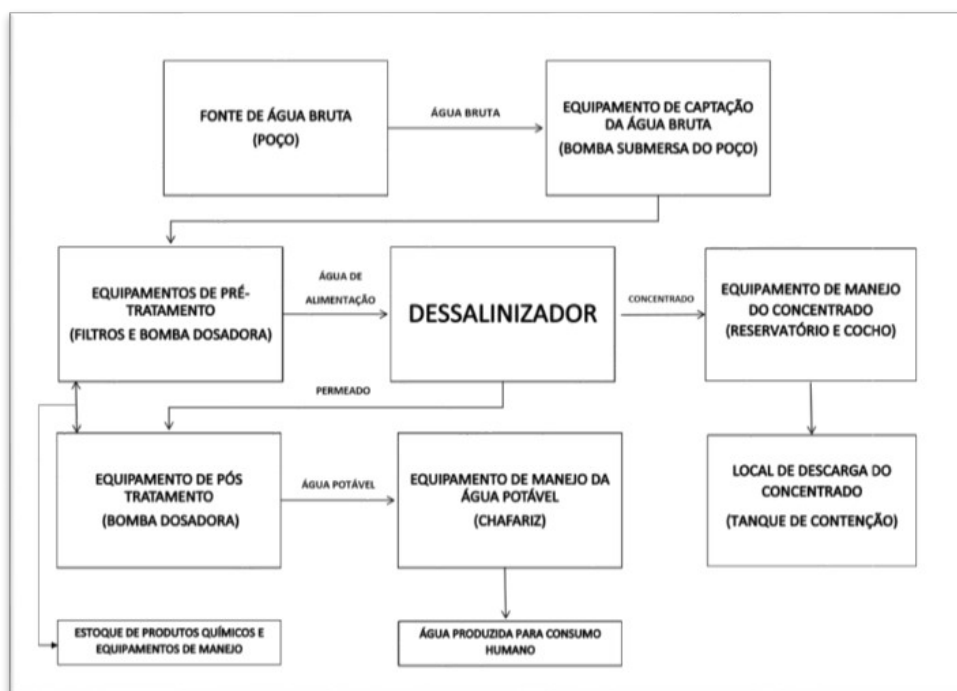
Figura 2: Fluxograma do sistema de dessalinização do PAD.
