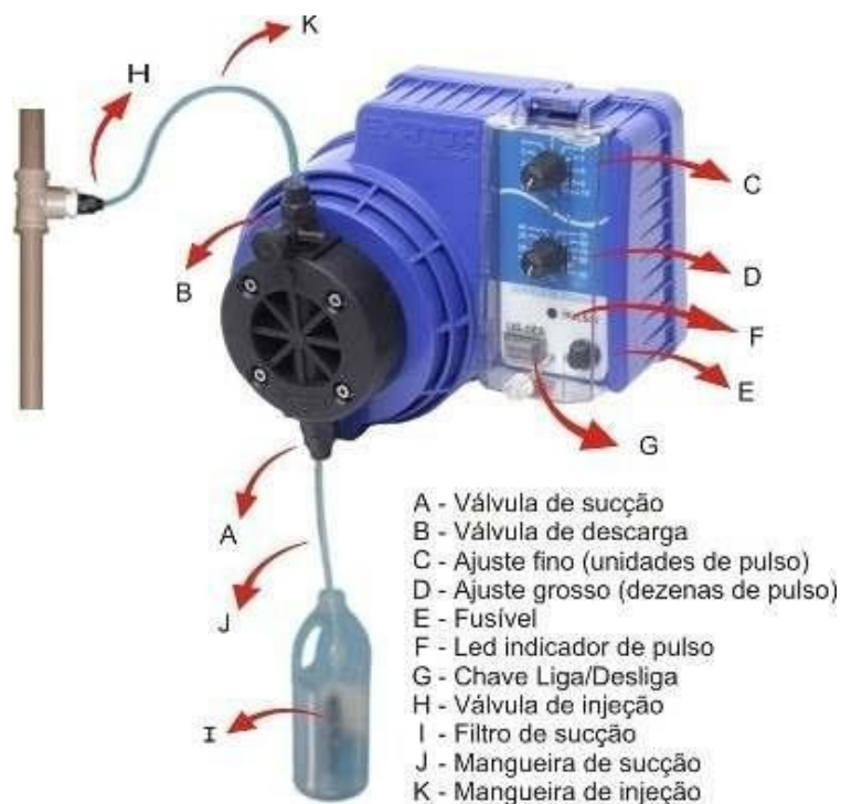
Figura 2: Bomba dosadora e seus componentes.
