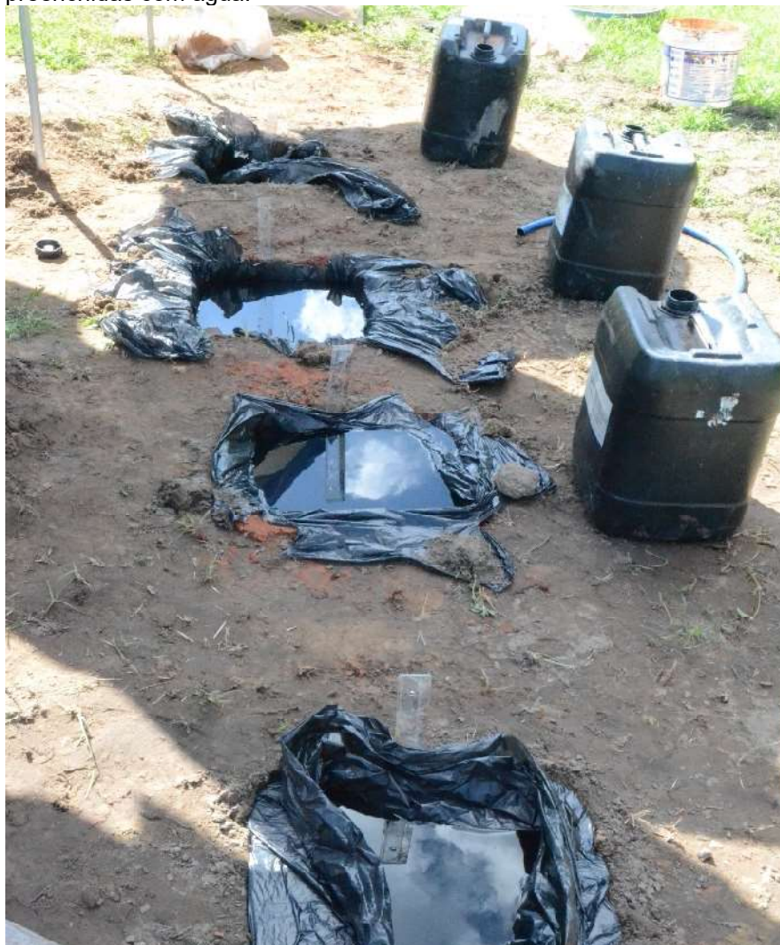
Figura 40 – Cavas protegidas com saco plástico de 100 litros, e preenchidas com água.
