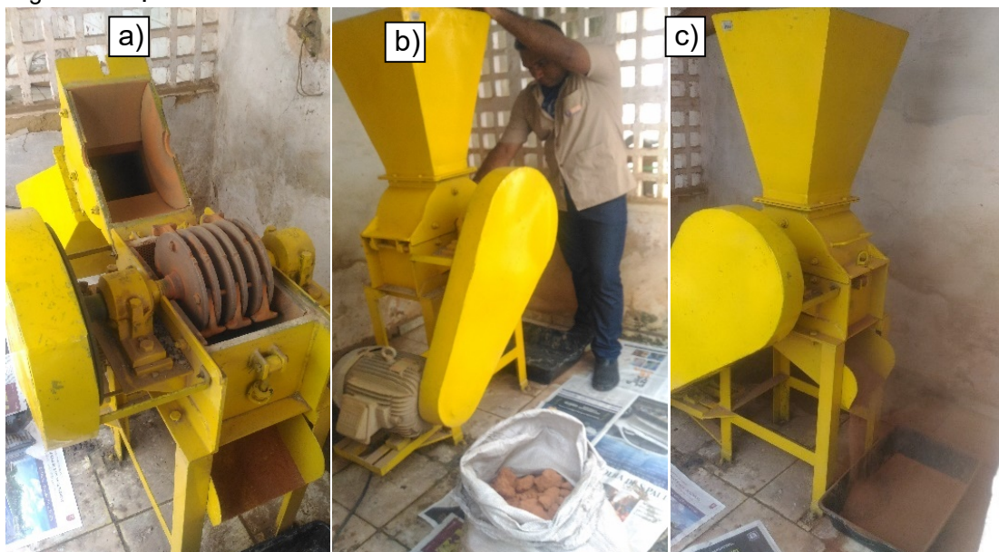
Figura 36a- visão interna do moinho de martelo; b- material sendo colocado no moinho; c- argila moída.
