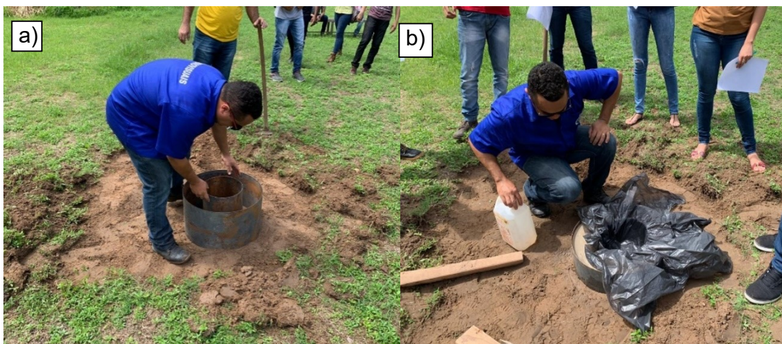
Figura 33a – enterrando os anéis no solo. Figura 33b - colocação do plástico no anel interno.
