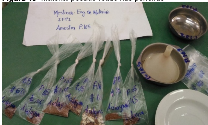
Figura 19- Material pesado retido nas peneiras
