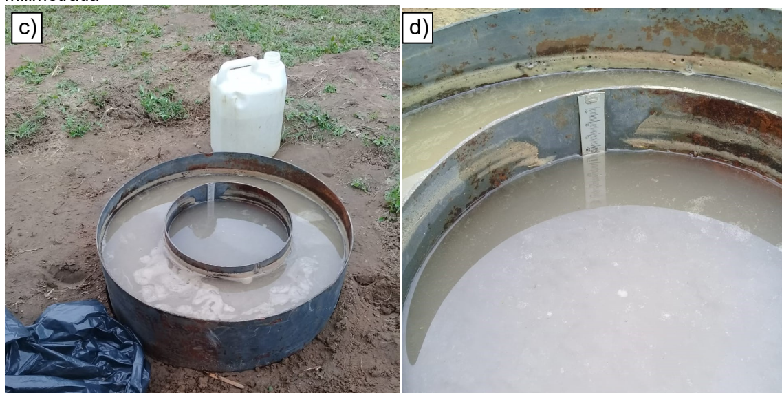
Figura 34c – adição de água no anel interno e retenção do plástico; d - leitura na régua milimetrada
