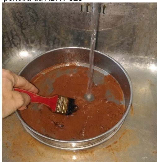
Figura 17- Lavagem da argila na peneira da ABNT 325
