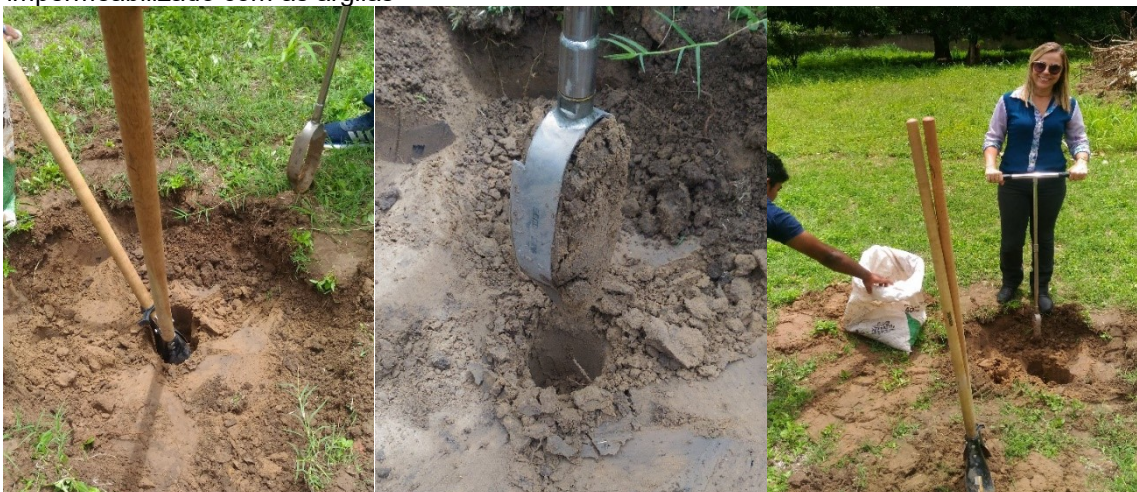
Figura 32 – Etapas de coleta de material para sondagem do solo do local a ser impermeabilizado com as argilas
