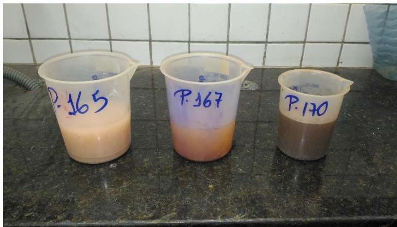
Figura 16- Defloculação da argila em água e amônia
