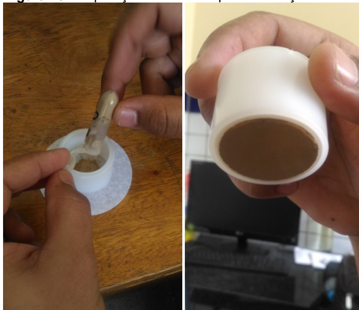
Figura 25- Preparação da amostra para realização do FRX
