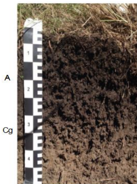
Figura 13. Perfil 04 - GLEISSOLO HÁPLICO Tb Distrófico léptico e paisagem da área de ocorrência.
