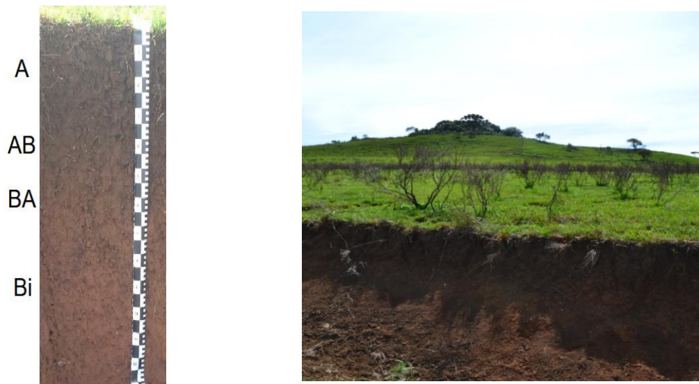
Figura 10. Perfil 01 - CAMBISSOLO HÁPLICO Tb Alumínico típico e paisagem da área de ocorrência.
