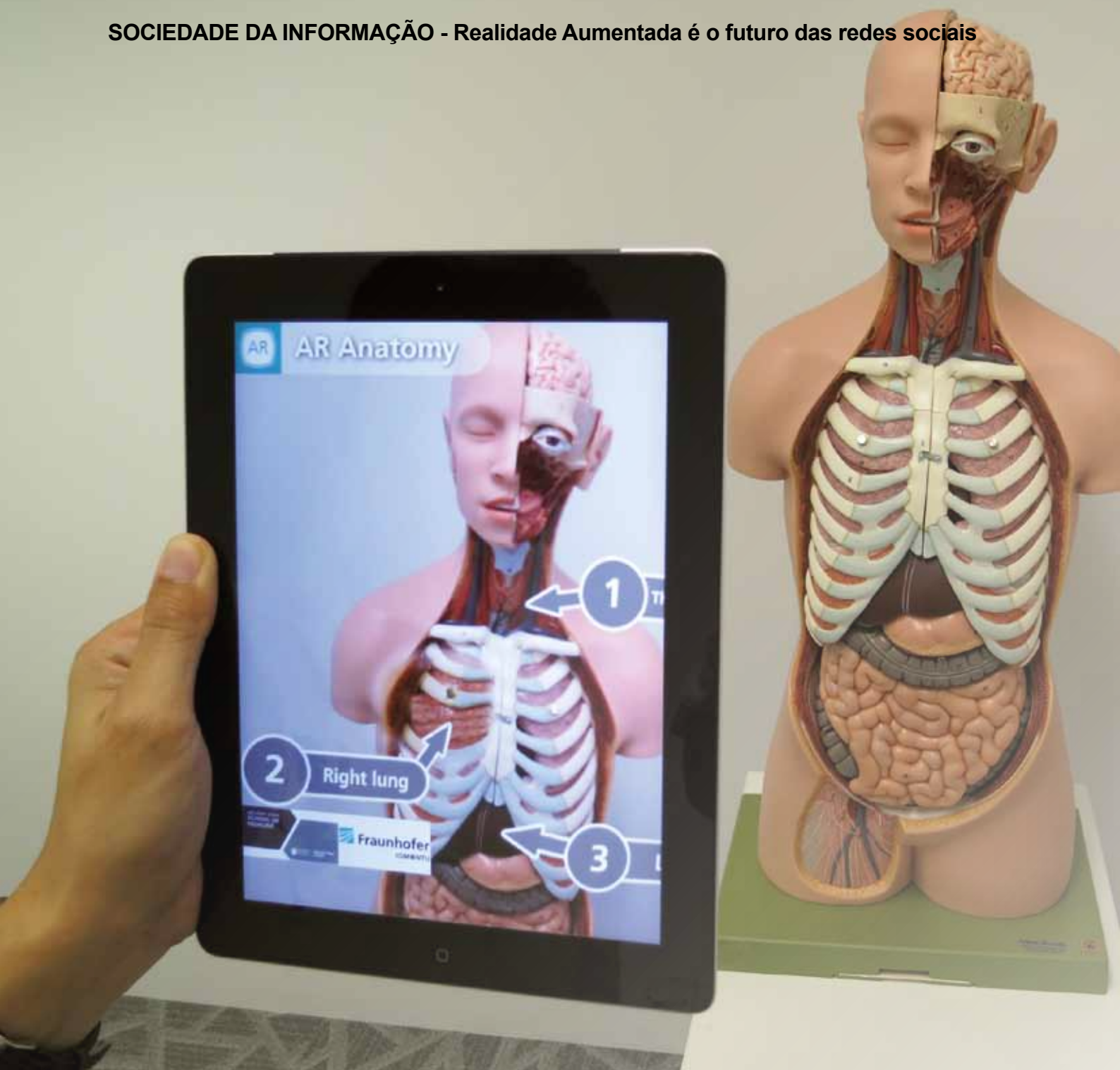
Software de RA “lê” o espaço físico e acrescenta a seus objetos elementos que agregam informações e reagem às ações dos utilizadores
