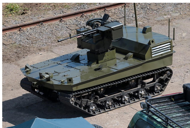
Figura 08: RPV terrestre russo da série “Lobo” Fonte: (VOLTOLINI, 2014)
