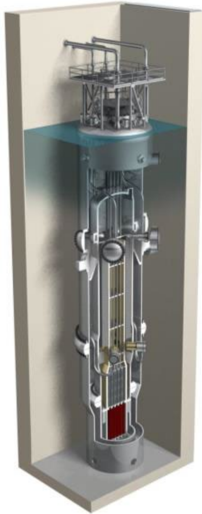
Figura 1: Corte esquemático vertical de um módulo SMR tipo PWR (NuScale). Fonte: IAEA (2024)
