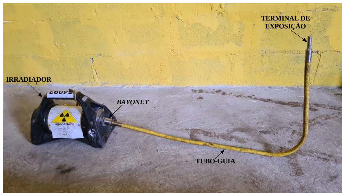
Figura 6: Tubo-guia acoplado ao irradiador pelo conector ( bayonet ), com seu terminal de exposição na extremidade (TATIANA, 2023).
