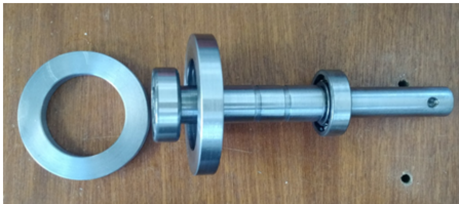
Figura 9 – Disco Principal (esquerda) e pistão já com os rolamentos (direita). O Autor.
