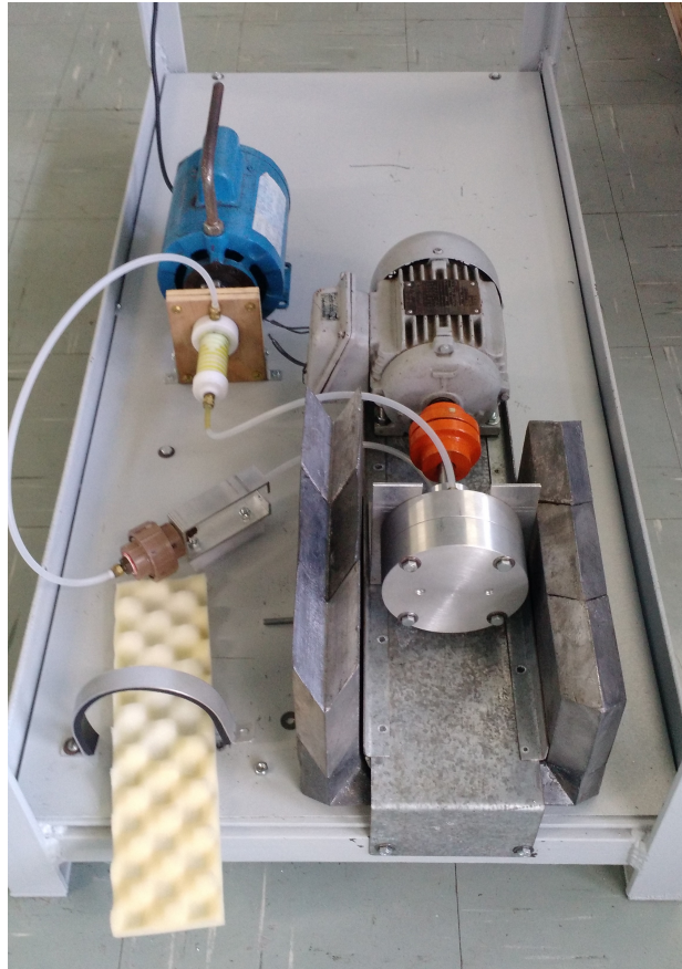
Figura 13 – Desbastador e sistema de lubrificação/transporte de limalha. O Autor.
