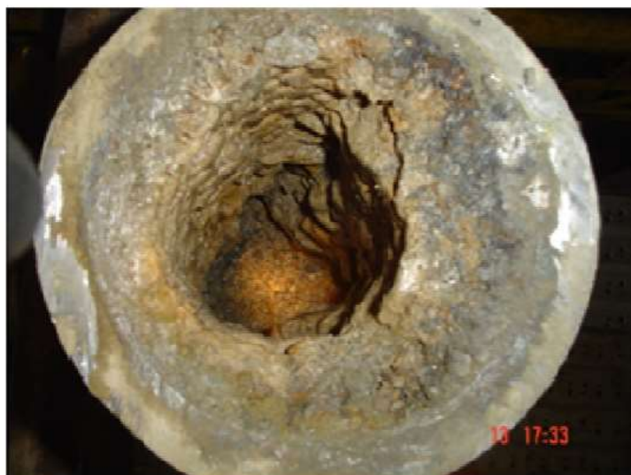
Figura 1: Duto com incrustação \text{BaSO}_4 (Petrobrás, 2013)
