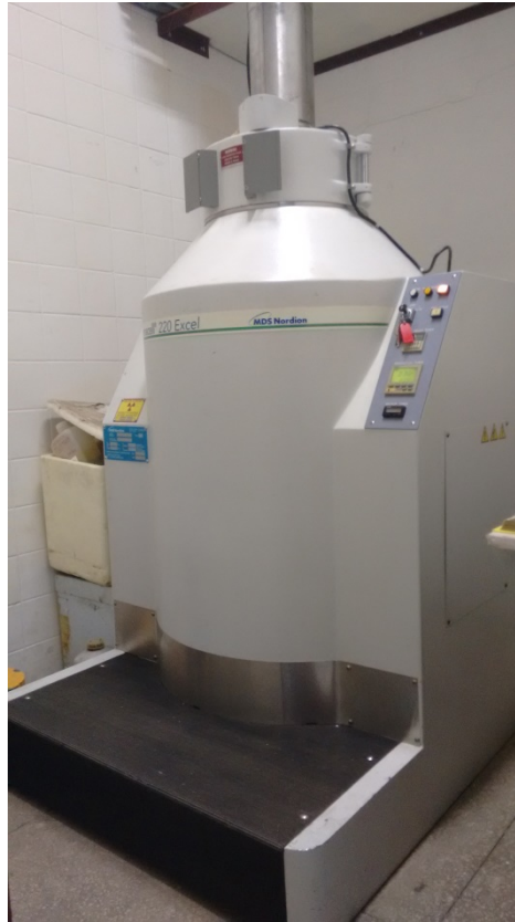
Figura 3.3: Irradiador multipropósito MDS Nordion Gamacell Excel 220 instalado no Laboratório de Instrumentação Nuclear, COPPE / UFRJ [O autor, 2017].
