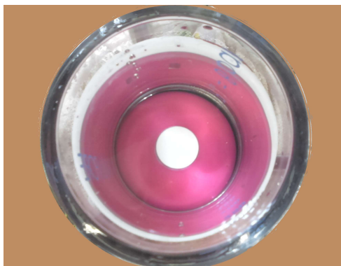
Figura 7.15 – Vista superior da célula da Milipore, com o suporte inserido (região branca).
