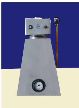
Figura 7.5 – Prensa uniaxial utilizada na compactação dos suportes cerâmicos.
