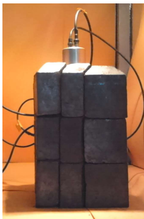
Figura 7.12 – Arranjo experimental, evidenciando a blindagem de chumbo.
