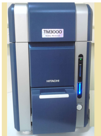
Figura 7.21 – Microscópio eletrônico de varredura, HITACHI, modelo TM3000.
