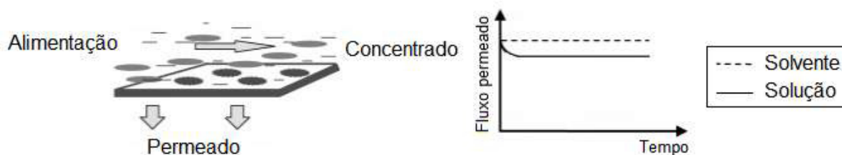
Figura 5.6 – Diagrama esquemático da filtração em escoamento tangencial (HABERT, 2006).
