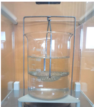
Figura 7.10 – Aparato experimental para a determinação da porosidade pelo método de Arquimedes.
