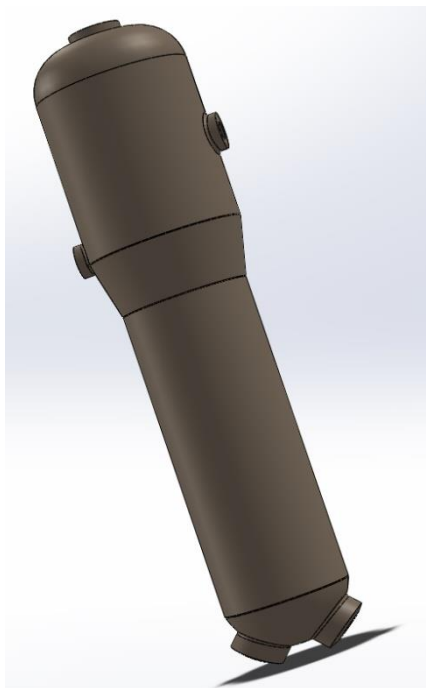
Figura 32 - Gerador de vapor- vista isométrica modelada no SolidWorks - fonte: acervo pessoal
