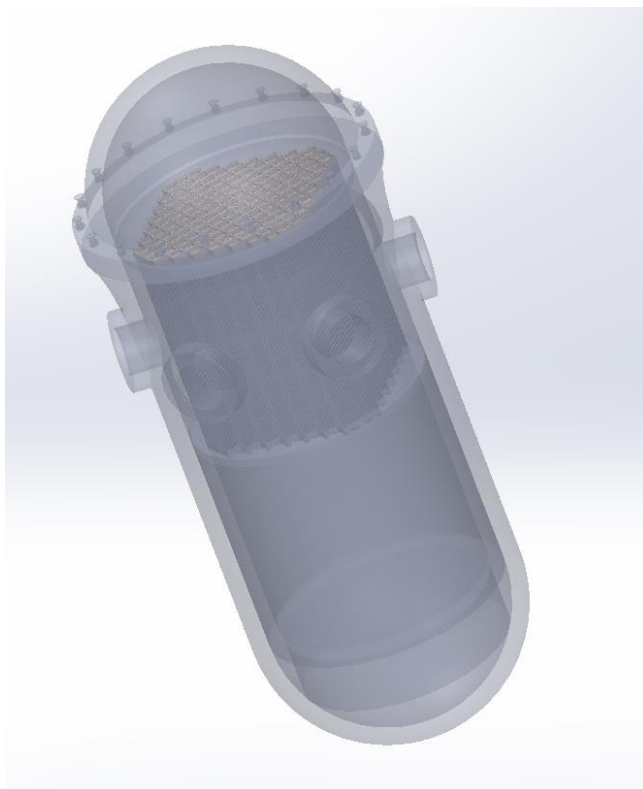
Figura 27 - Vaso do reator - vista isométrica com transparência modelada no SolidWorks fonte: acervo pessoal.
