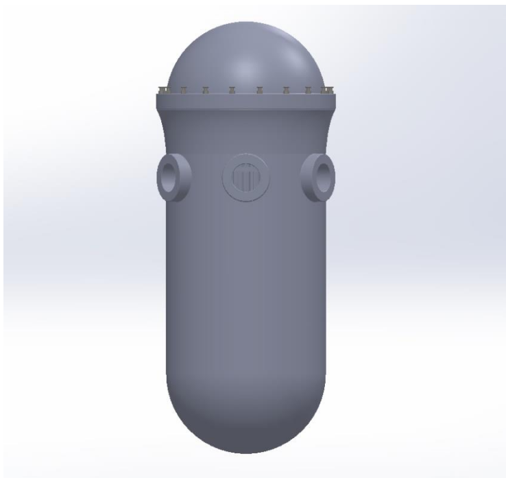
Figura 25 - Contenção do reator modelada no SolidWorks - vista lateral/frontal fonte: acervo pessoal.
