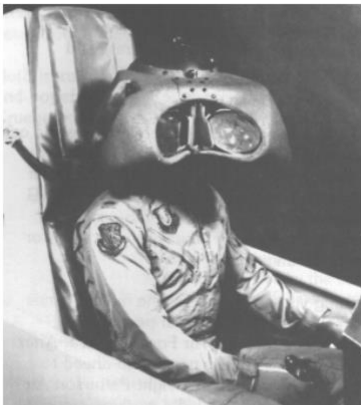
Figura 3 - Piloto usando o capacete do projeto Super Cockpit (PIMENTEL, 1995).
