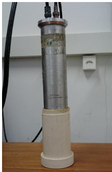
Figura 17: Detector posicionado no suporte para medição da resolução. (Fonte: PEIXOTO, 2016)
