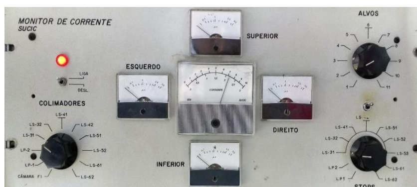
Figura 22: Medidores de Corrente na Câmara e Fendas da linha 2
