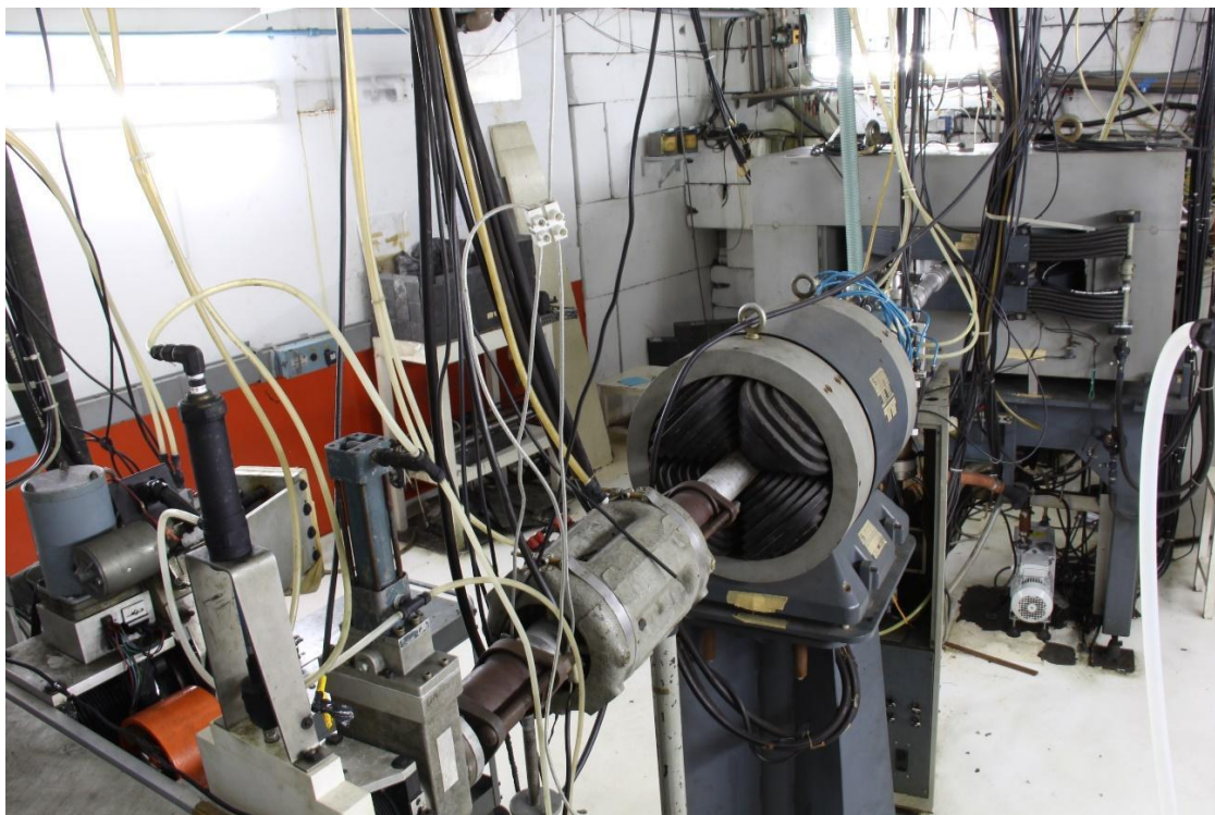
Figura 4: Linha Principal do CV-28 – Lente quadripolar e Distribuidor Magnético.
