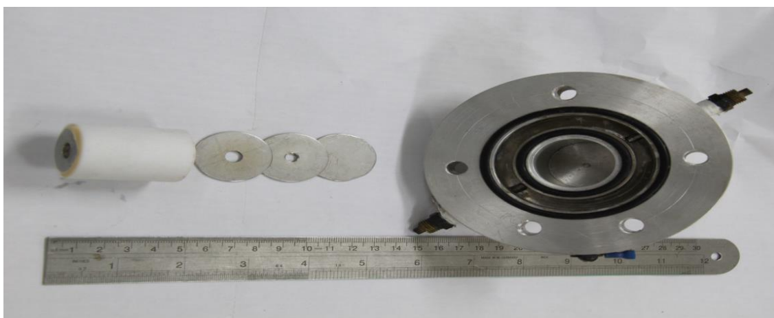
Figura 24: Colimador de 9 mm, placas de aço e Porta Alvos da Câmara de Irradiação Instalada no CV-28.
