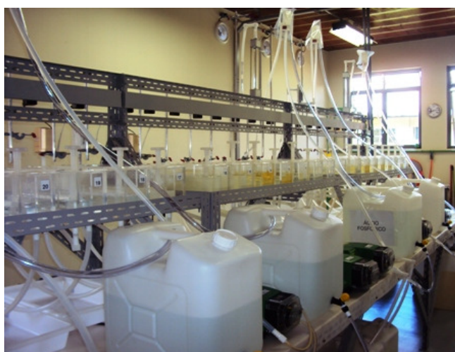
Figura 12: Planta piloto de obtenção de urânio por extração de solventes ( www.inb.gov.br )
