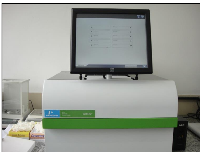
Figura 22. Contador gama (Perkin Elmer modelo Wizard® 2470) utilizado na determinação da contagem radioativa nos estudos cromatográficos e de biodistribuição.
