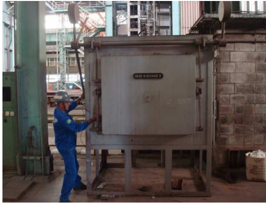
Figura 30 – Forno elétrico utilizado para o tratamento de alívio de tensões na amostra 20 MnMoNi 55
