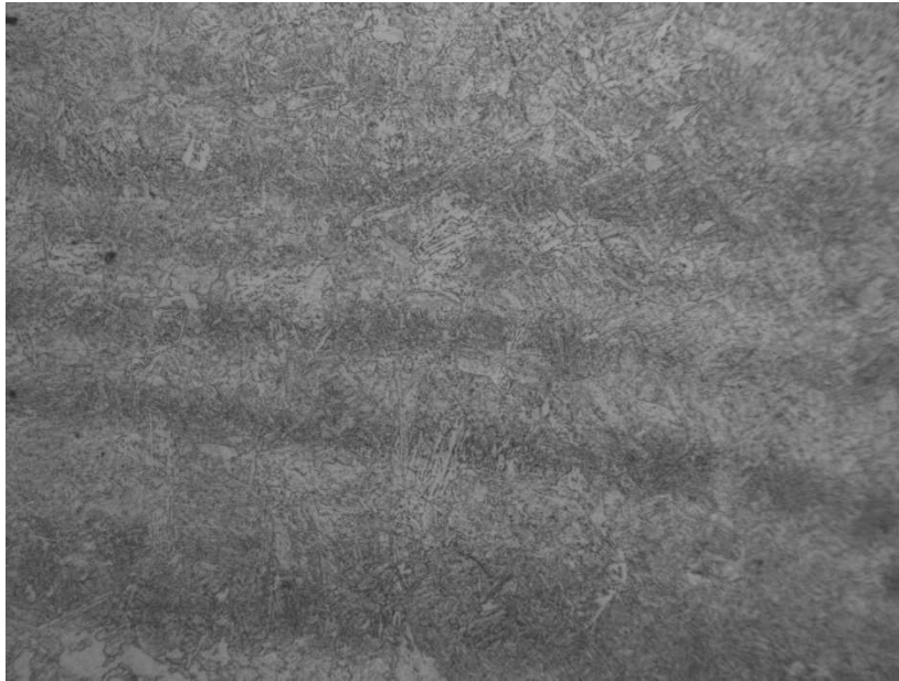
Figura 38 – Microestrutura do metal de base. 200X
