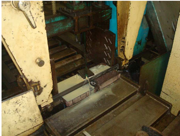
Figura 33 – Corte da amostra 20 MnMoNi 55 para preparação dos corpos de prova
