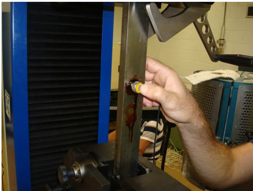
Figura 36 – Aquisição de sinais ultrassônicos no CP TR1
