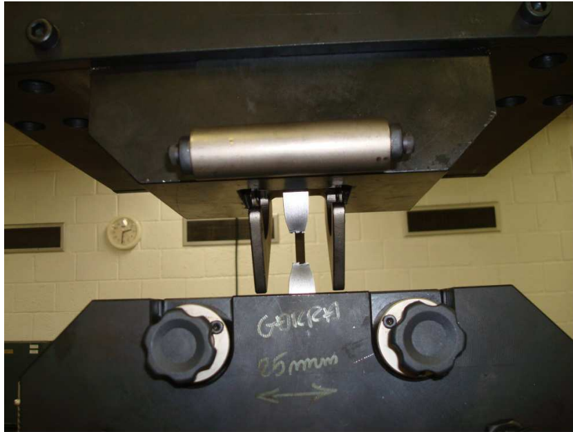
Figura 41 – CP TR3 após a ruptura na máquina de ensaio de tração
