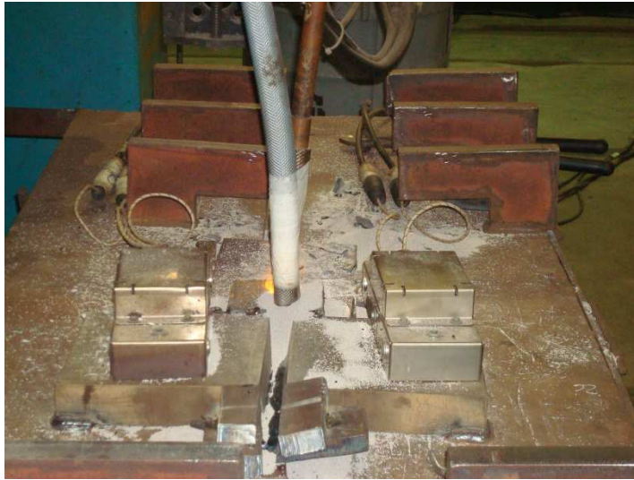
Figura 25 – Soldagem da amostra 20 MnMoNi 55 através do processo SAW
