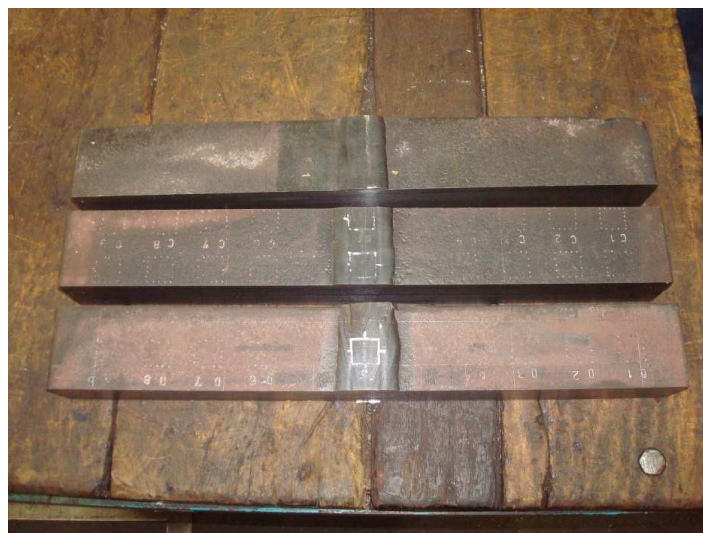
Figura 34 – Amostra 20 MnMoNi 55 cortada
