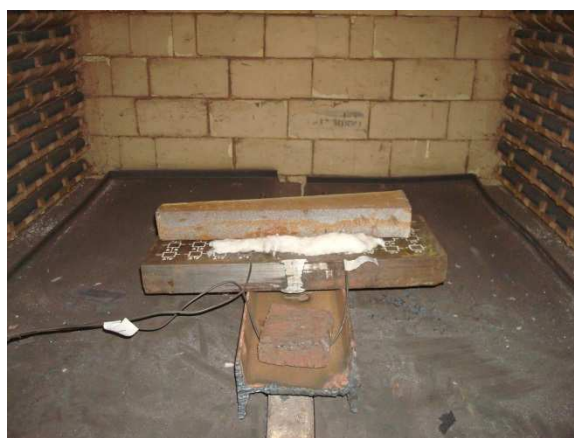
Figura 29 – Preparação da amostra 20 MnMoNi 55 antes do tratamento térmico
