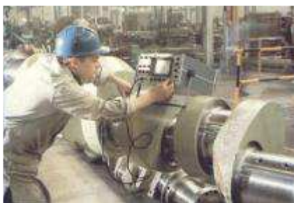
Figura 10 - Inspeção por ultrassom de um virabrequim (Foto extraída de trabalho técnico da Krautkramer)
