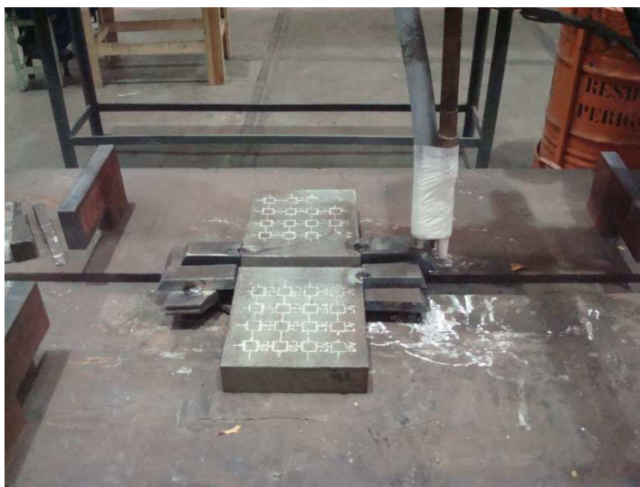
Figura 24 – Chapas de entrada e saída soldadas na amostra
