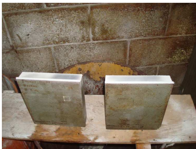
Figura 23 – Ensaio de líquido penetrante no chanfro da amostra 20MnMoNi 55
