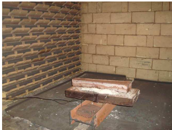
Figura 31 – Amostra 20 MnMoNi 55 após o tratamento térmico de alívio de tensões
