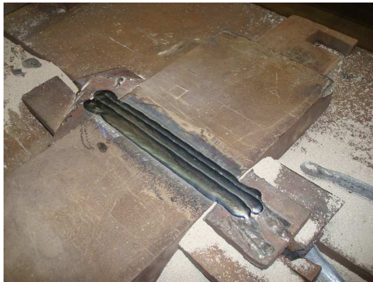
Figura 26 – Término da soldagem da amostra 20 MnMoNi 55
