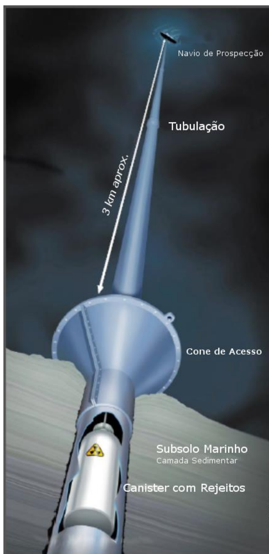
Figura 07: Representação do procedimento sub-seabed . Fonte: Adaptação pelo Autor (2014)
