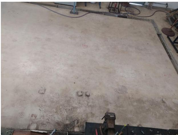
Após o alívio de carga foi realizada nova inspeção visual detalhada no piso, conforme registro ao lado. Constatamos que não houve nenhuma fissuração visível causada pelo teste de carga, o que já era esperado pela baixa flecha medida ( $<1/1.000$ ). Este resultado de flecha está dentro do estado limite de serviço da estrutura com folga.
