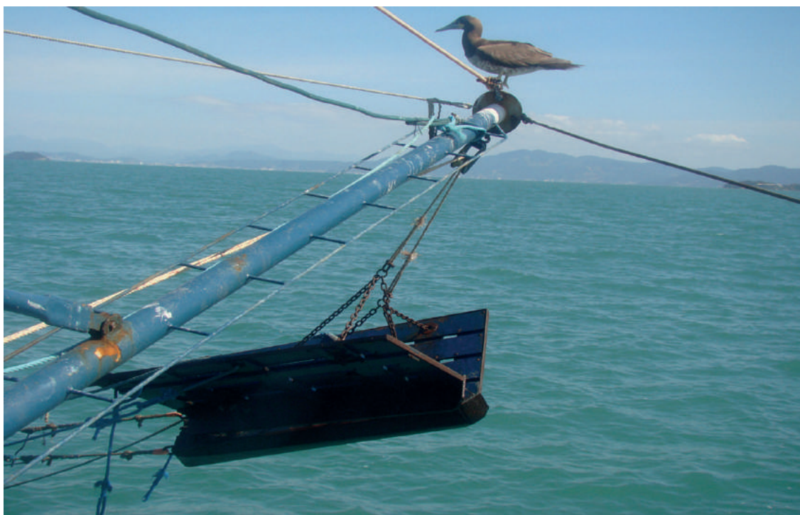
Figura 20: Tangone e porta de uma embarcação.
